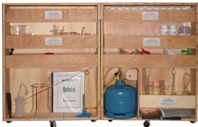
Armário de madeira tratada e envernizada, com rodízios, alça para transporte, dobradiças e fechadura com chaves. Parte traseira com fendas para circulação de ar.
